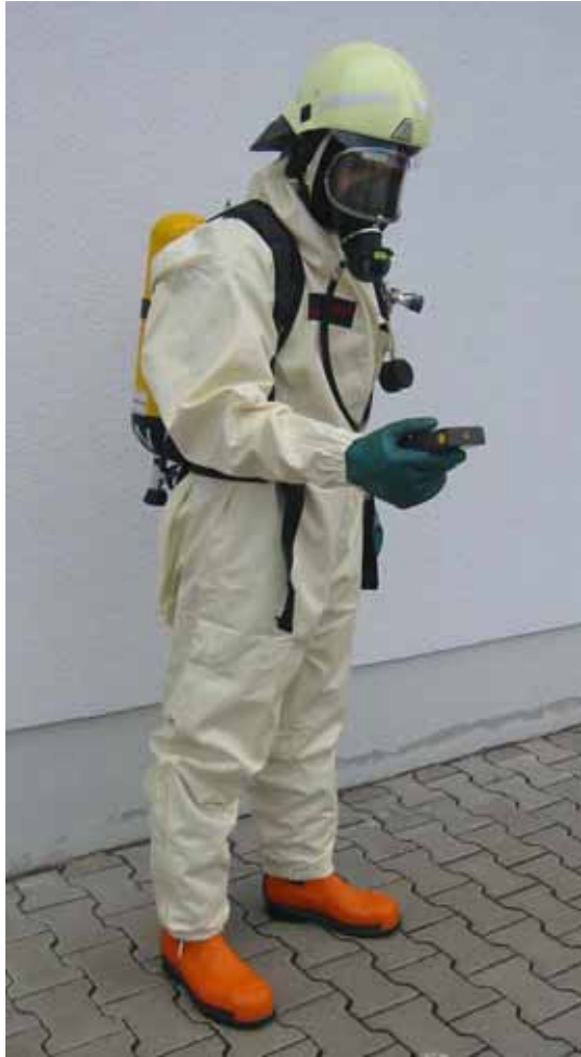
Abbildung 3: Beispiel einer Körperschutz Form 2 für den A-Einsatz: Kontaminationsschutzanzug nach EN 1073 Teil I und II mit mechanisch belastbaren Chemikalienschutzhandschuhen sowie Gummistiefel
