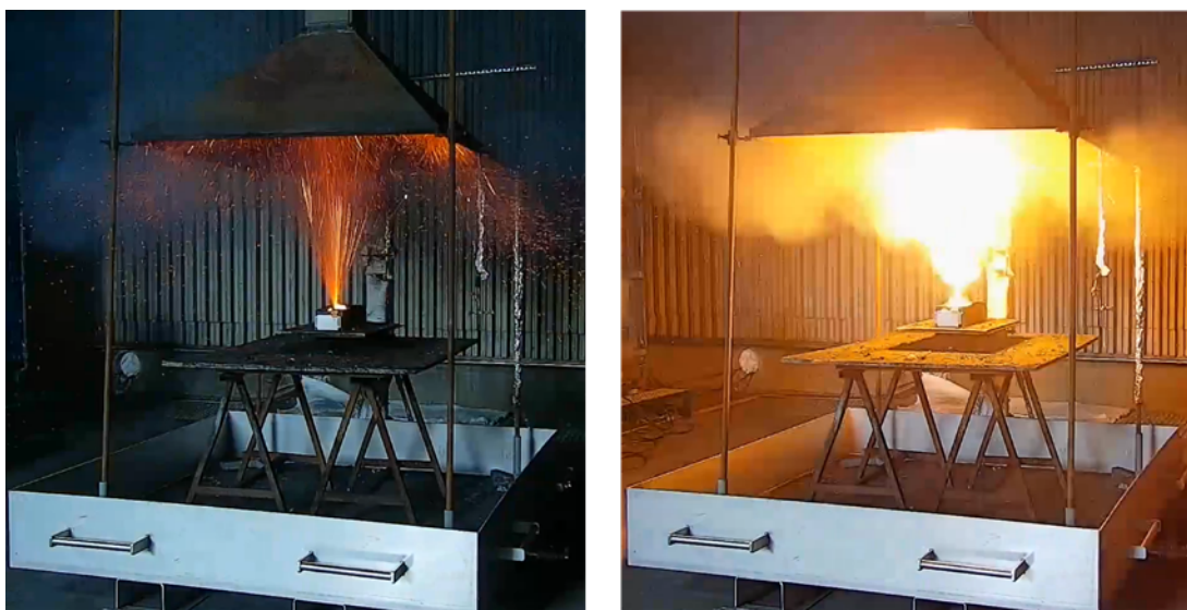
Abb. 18 Beispiele für Funkenflug und Stichflammen aus einem Modul, wie sie in HV-Speichern für Fahrzeug verbaut sein können (Neske, et al., 2022)
