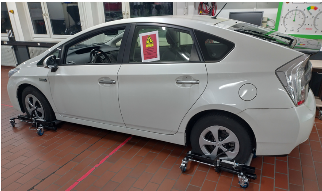
Abb. 25 Eine Möglichkeit für Einsatzkräfte ein nicht mehr fähiges Fahrzeug aus einer baulichen Anlage zu verbringen sind z. B. Rangierhilfen.
