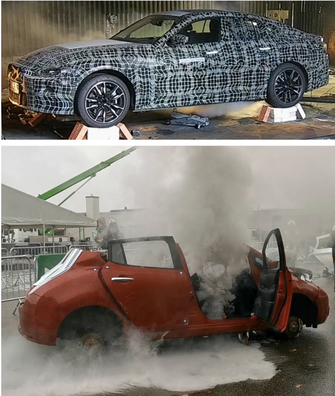
Abb. 17 Austretende Ventinggase aus Fahrzeugen mit HV-Speicher 14 (Neske, et al., 2025)
