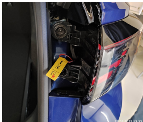
Abb. 20b Trennen der Pilotlinie
