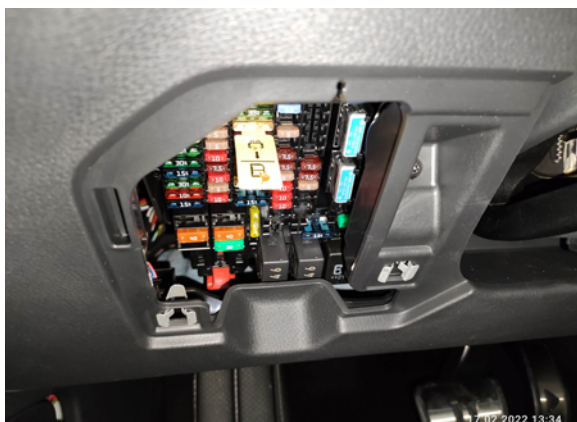
Abb. 20a Deaktivierung des HV-Systems durch Entfernen der Sicherung oder
