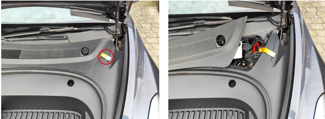
Abb. 21 Beispiel zur Position und Kennzeichnung der Steuerleitung
